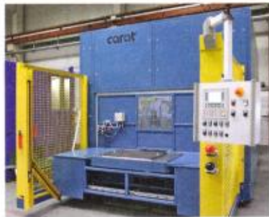
Putzroboterzelle: Eine Schallschuttkabine sorgt für die nötige Kapselung und damit Sicherheit
