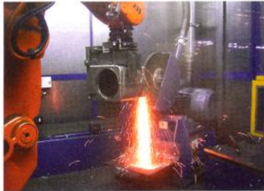
Putzen eines Bauteils: Kernstück der Anlage ist der ABB Roboter IRB 6600 mit einer Handhabungskapazität von 225 kg
